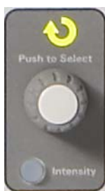
Figura 7 Control de entrada general del osciloscopio
