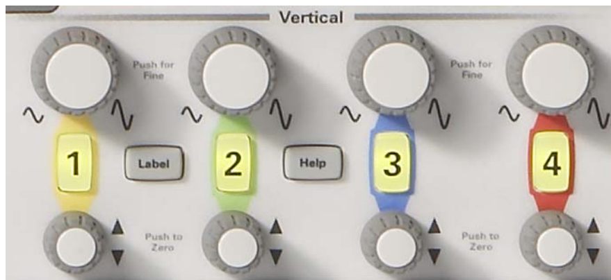
Figura 5 Controles verticales del osciloscopio (eje Y)
