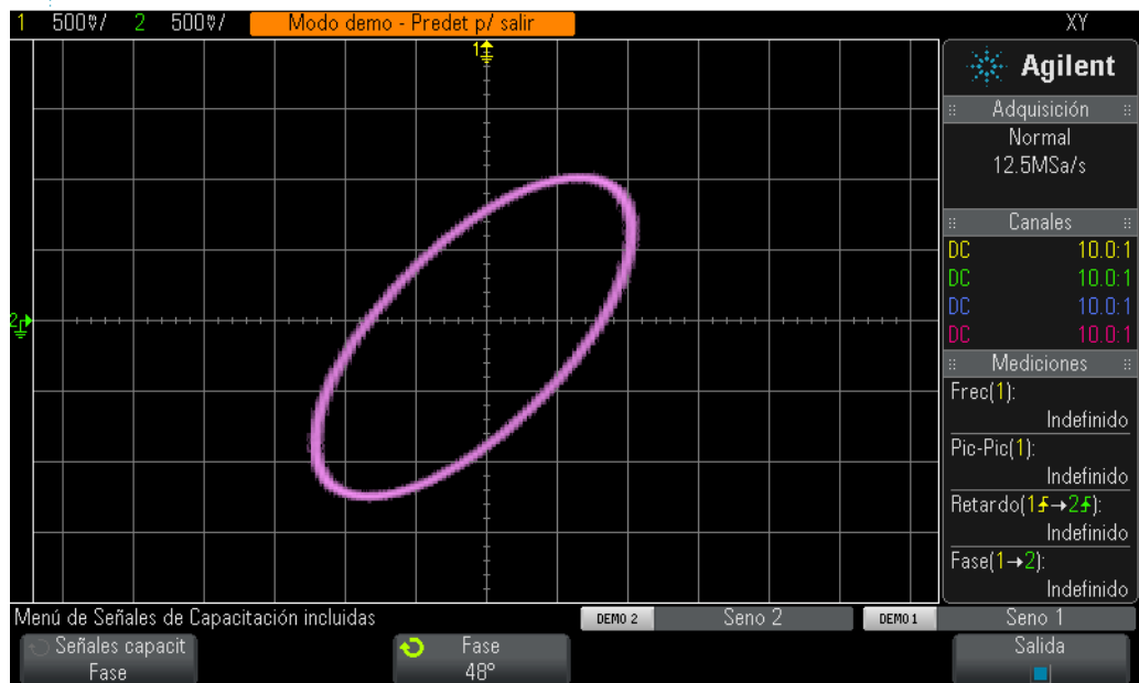
Figura 40 Un patrón Lissajous con un modo XY del osciloscopio de dos ondas sinusoidales de la misma frecuencia, pero 48 grados desfasadas entre sí
