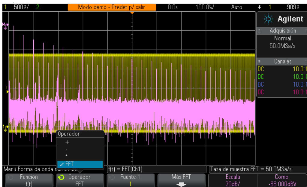
Figura 43 Realización de una función matemática FFT en un reloj digital repetitivo
