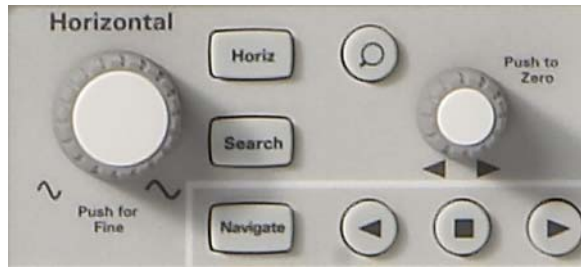
Figura 4 Controles horizontales del osciloscopio (eje X)
